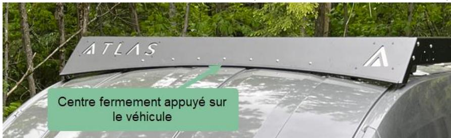
2.5 Refaire une vérification finale de la position gauche/droite et avant arrière du rack du le véhicule
