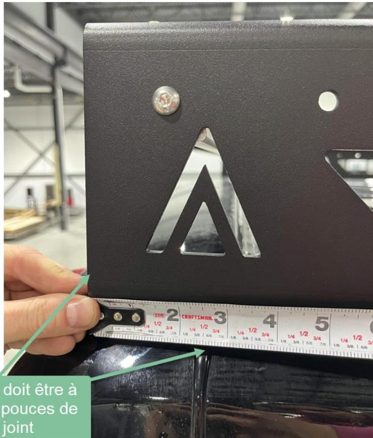
2.2. Centrer le rack parfaitement sur le véhicule (gauche/droite)
