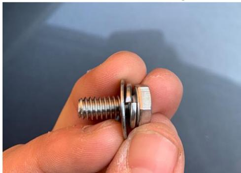
1.6. Insérer l'assemblage au travers du panneau solaire et visser manuellement dans la "spring nut".
