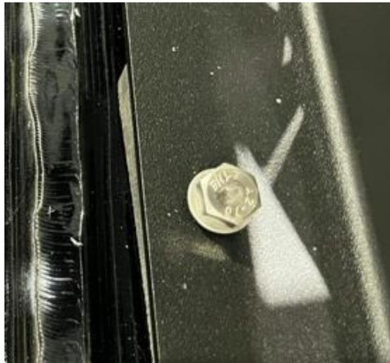
4.10 À l'intérieur du véhicule, insérer les rondelles 5/16" et visser manuellement à nouveau les écrous M8. Ne pas serrer les écrous, car on doit conserver une flexibilité pour le côté opposé du rack.
