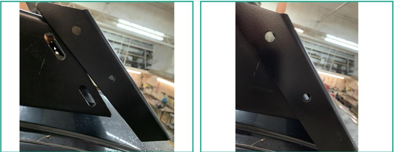
1.5.2 Insérer les boulons 3/8"-16 x 1." au travers du déflecteur et ensuite du longeron.
