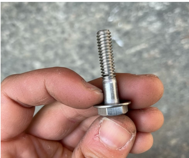
4.3 Insert a 1/4" washer onto a 1/4" x 1.25" bolt.
