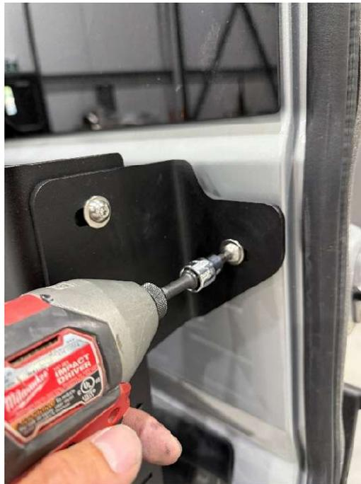
6.12. Serrer tous les boulons de l'assemblage à un torque de 30 Nm.
