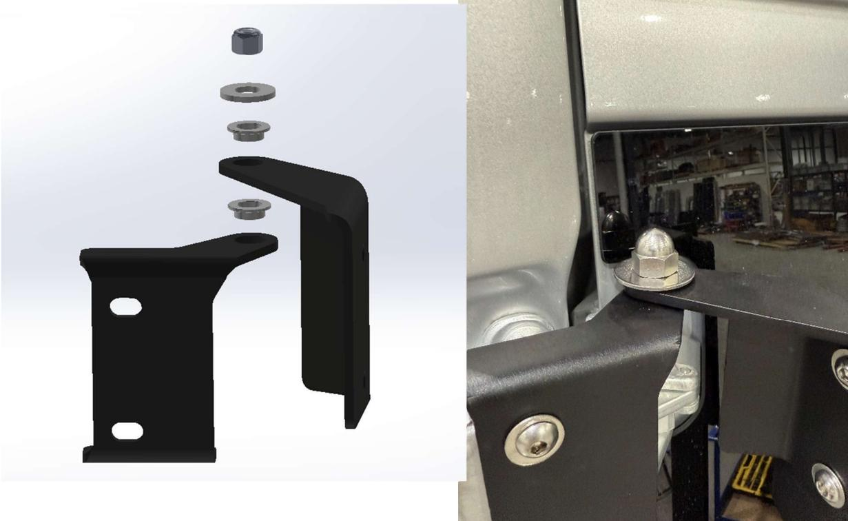
4.5. Répéter les étapes précédentes pour ajouter les 2<sup>e</sup> boulons et s'assurer que le chargement est bien distribué entre les deux supports. Sinon, utiliser les ajustements dans la plaque du support de porte.
