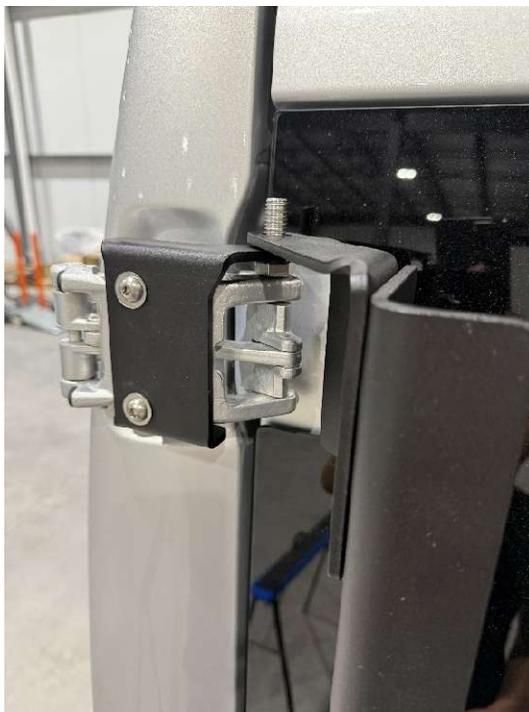
4.2. Insérer la rondelle sur le boulon. Insérer le boulon au travers la plaque intermédiaire et du support du bas.
