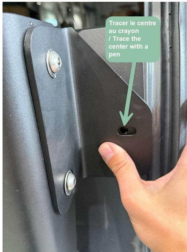
6.5. Percer à l'aide d'une mèche 3/16'' la paroi extérieure + la 2<sup>e</sup> paroi à l'intérieur de la porte (il y a donc 2 tôles à percer 3/16'')
