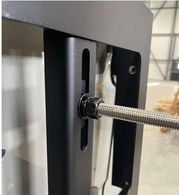
7.3. Positionner le boulon selon de rayon de votre pneu et serrer fortement l'assemblage en place
