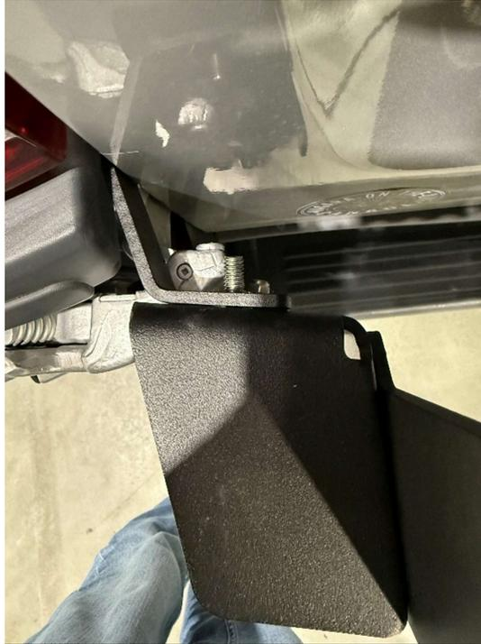
4.4. Placer la rondelle ainsi que l'écrou sur le boulon épaulé du haut. Serrer à 10 Nm.
