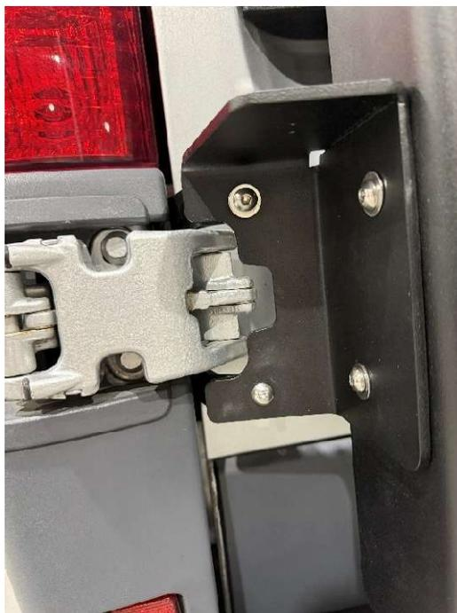
4.3. Insérer une rondelle et visser un écrou manuellement.
