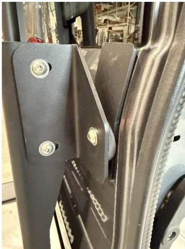
6.9. De l'autre côté, insérer le néoprène et la plaque renfort sur le boulon dans cet ordre.
