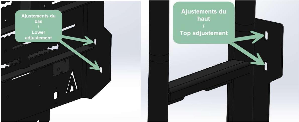
4.6. Serrer les 4 boulons reliant le support aux 2 plaques de peinture à un torque 30 Nm avec clé Allen et clé à cliquet.
