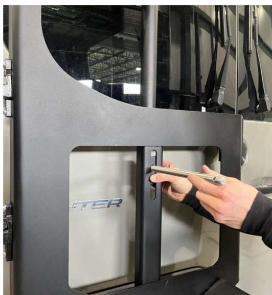
7.2. Insérer une rondelle plate, une rondelle de blocage et visser l'écrou au complet.
