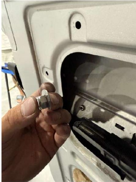
6.11. Serrer l'assemblage jusqu'à ce que le néoprène extérieur soit légèrement bombé. Approximativement 12-16 Nm.
