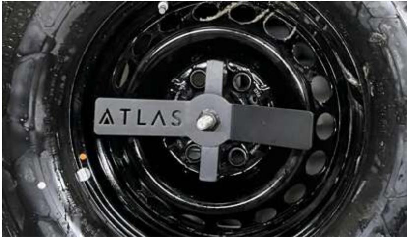
7.7. Visser le boulon  $\frac{1}{4}$ " dans le trou au bout du boulon  $\frac{5}{8}$ " et visser l'écrou sur le boulon pour barrer le tout en place
