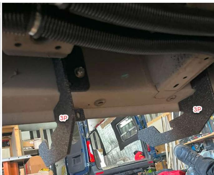
4. Installer les boulons à tête hexagonale ¼" x 1.25" dans les trous oblongs.
