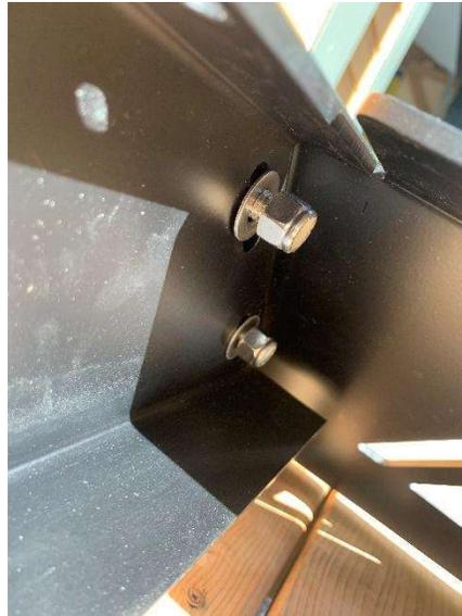
5.2.4. Serrer l'écrou légèrement à la main afin de sécuriser l'assemblage.
