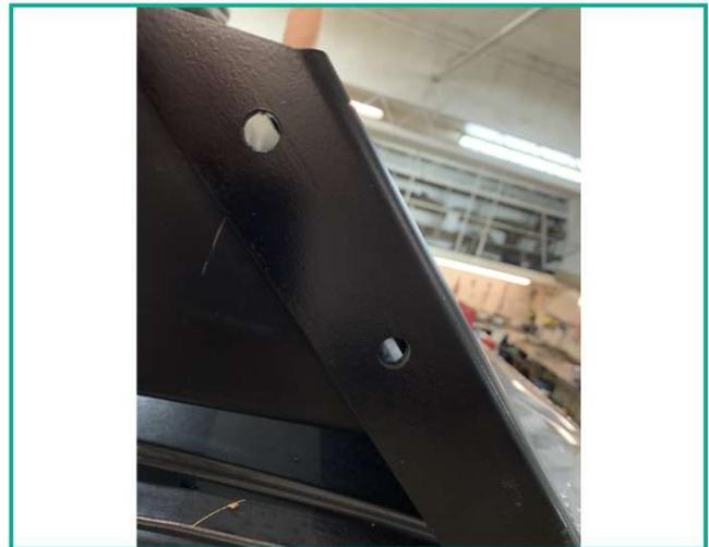
5.2.2. Insérer les boulons 3/8"-16 x 1." au travers du déflecteur et ensuite du longeron.
