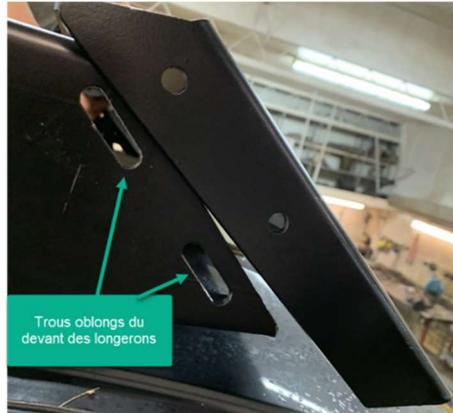
5.2.6. Serrer les 4 assemblages boulons/écrous à un couple de **16 N·m** à l'aide d'une clef dynamométrique.
