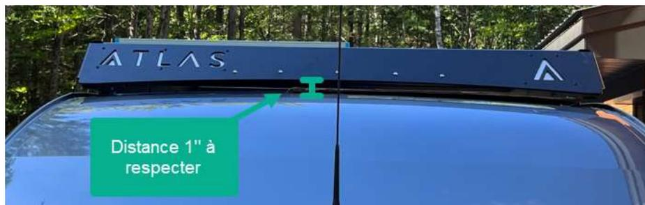
Pour ajuster cette distance, lever le déflecteur plus haut que les longerons à l'aide des trous oblongs permettant cet ajustement.
