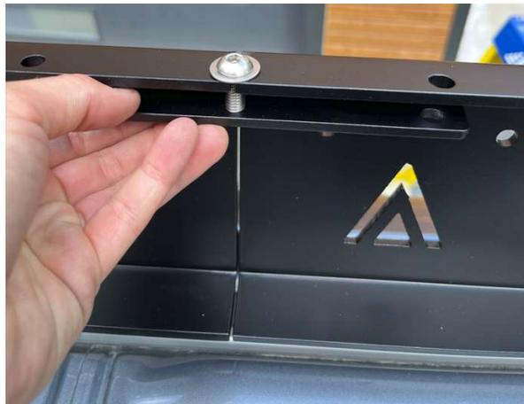
3.2 Insérer une rondelle d'espacement dans un boulon à tête ronde 5/16"-18 x 1".
