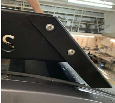
5.2.3. Insérer la rondelle d'espacement et l'écrou 3/8"-16.
