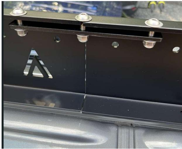
3.6 Exécuter le serrage final des 6 boulons des plaques de jonction à l'aide d'une clé dynamométrique.
