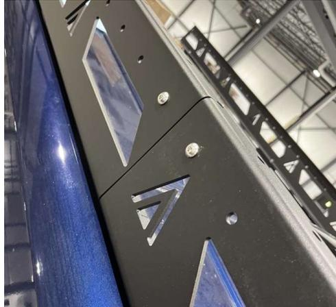
3.2 Insérer le boulon au travers du longeron et la plaque de jonction (rappel : mettre de l'anti-seize)
