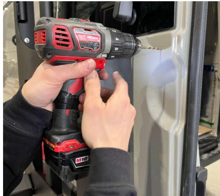
6.5. Percer les 2 parois avec une mèche  $3/8"$  ) (PHOTOS CÔTÉ CONDUCTEUR, MÊME PRINCIPE QUE CÔTÉ PASSAGER.)
