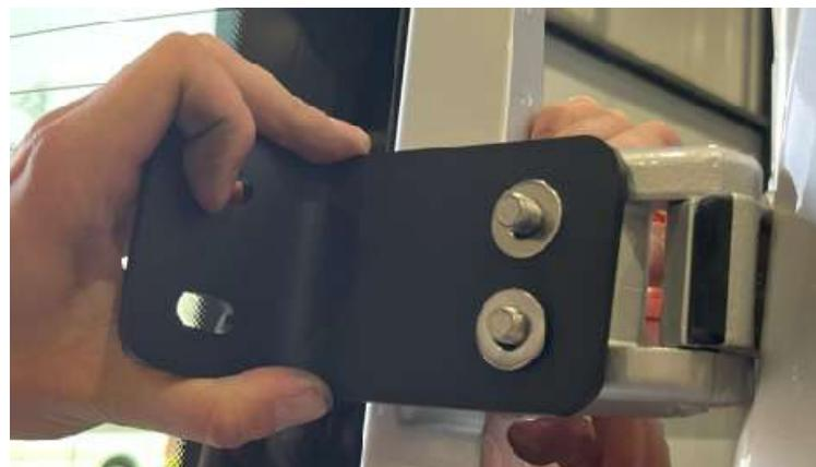
3.3. Serrer **légèrement** les boulons avec une clé à cliquet afin que les plaques. Important **qu'elles puissent encore bouger pour être ajustées.**
