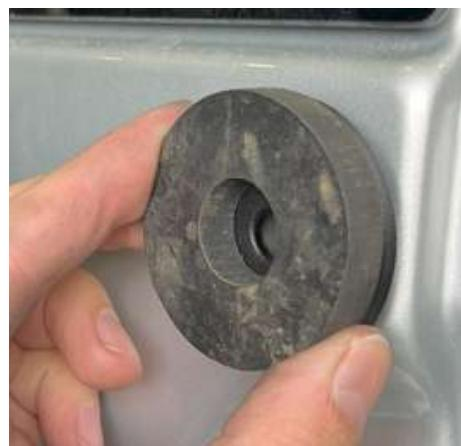
6.12. Insérer une rondelle sur le boulon 3/8" x 2 1/4". Insérer le boulon dans la plaque centrale
