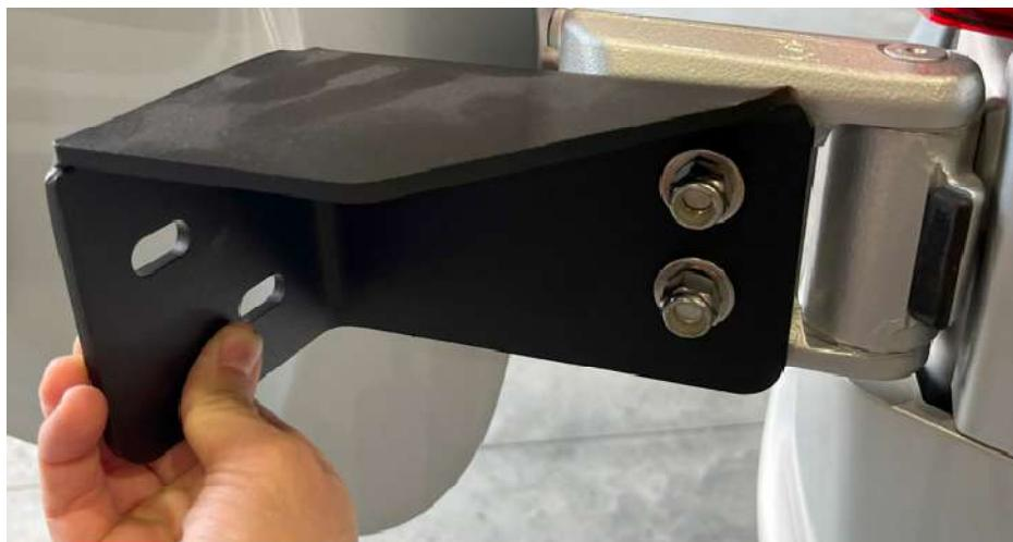
2.4. Serrer **légèrement** les boulons avec une clé à cliquet afin que les plaques. Important **qu'elles puissent encore bouger pour être ajustées**.
