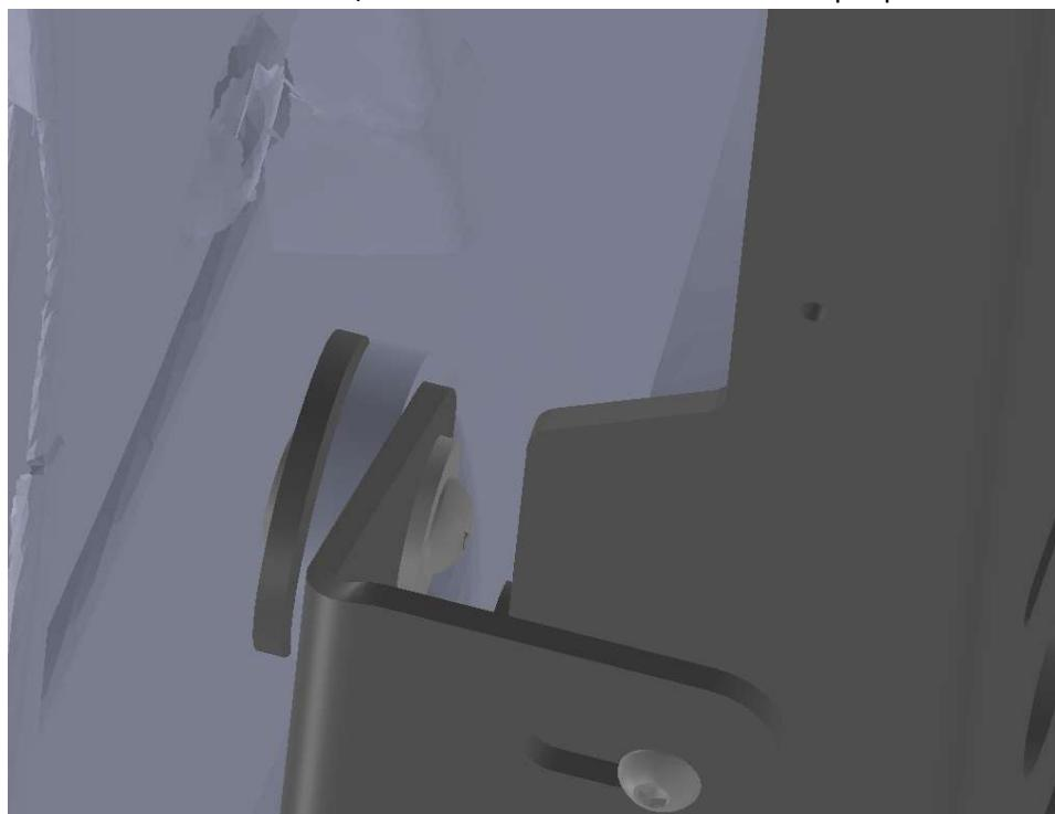
6.13. Insérer le boulon dans le néoprène et les alésages fait dans le véhicule
