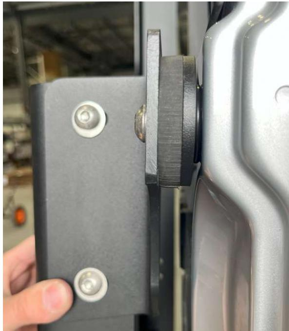
6.16. Serrer l'assemblage à un torque de 30 Nm.
