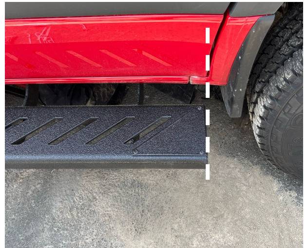
8.2 Ajuster le positionnement avant/arrière du marchepied. L'aligner avec le début de la porte passager avant.
