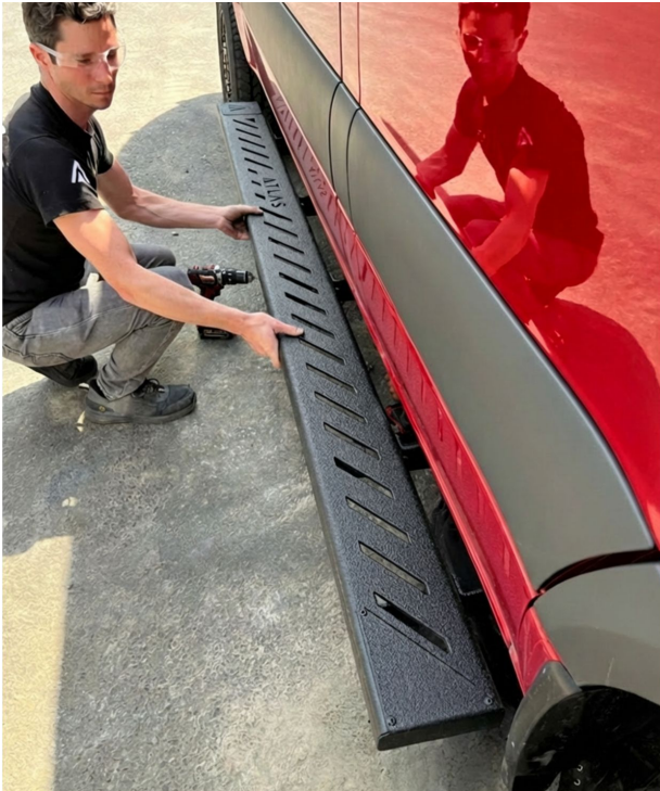
8.1 Déposer le marchepied sur les supports.
