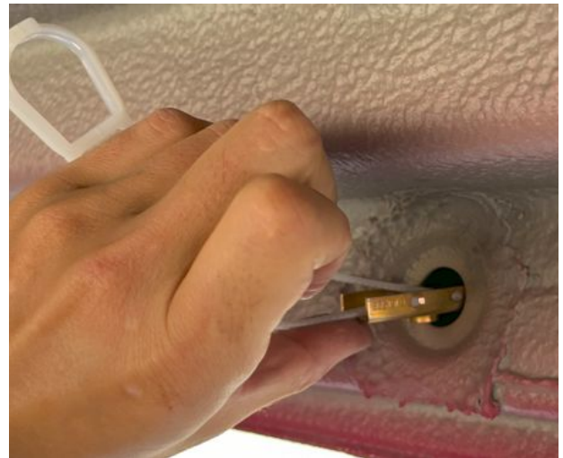
3.2 Tirer délicatement sur les lanières à dents jusqu'à ce que la rondelle soit appuyée sur le véhicule
