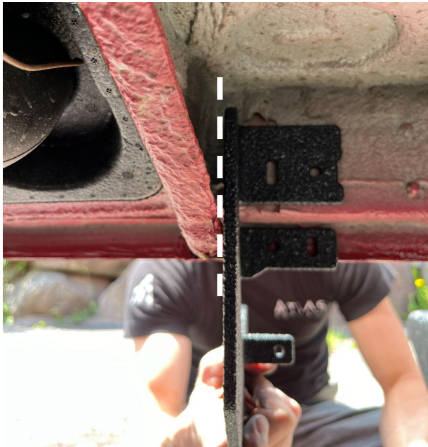
12.1 Coller le support 3D sur la membrure du véhicule
