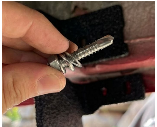
7.2 Insérer une rondelle de blocage 1/4" et une rondelle 1/4" sur un boulon auto-perçant #14 x 1.25"
