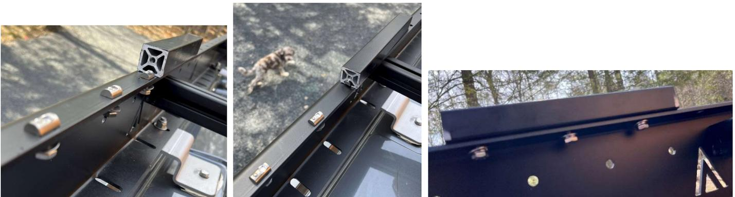
2.3 Serrer les 3 boulons à un couple de **12 N·m**.
