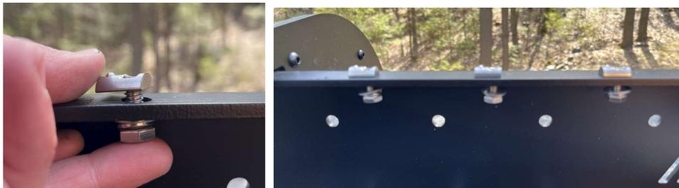
2.2 Glisser délicatement les écrous en T dans la fente du barreau supérieur jusqu'à ce que les écrous soient centrés dans le barreau.
