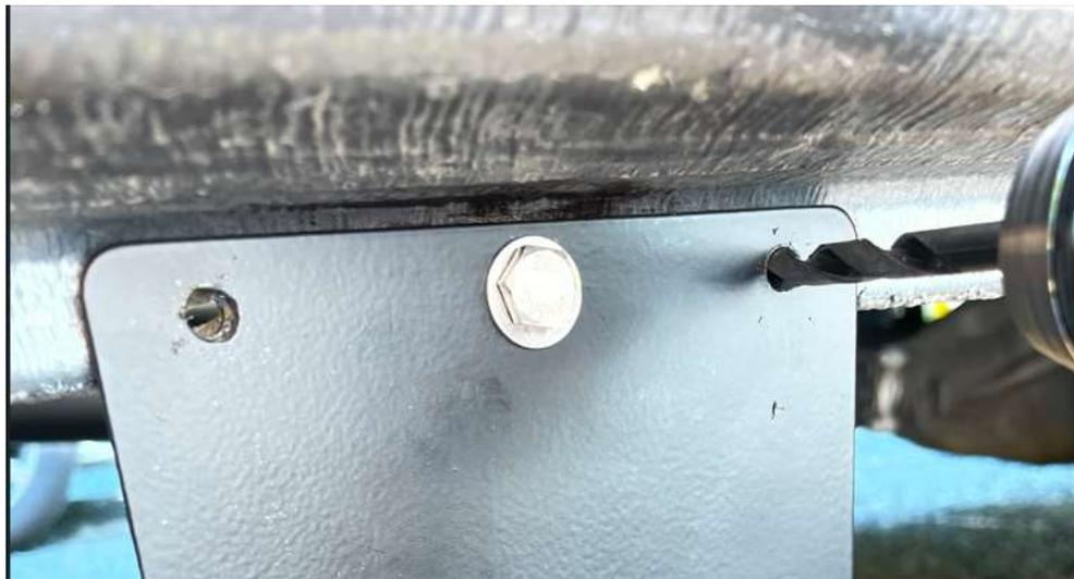
5.3 Percer les 3 trous d'assemblage à l'aide d'une mèche à métal 9/32". Insérer la mèche de métal directement dans les trous de la plaque de transition afin de percer exactement tel que la plaque de transition.
