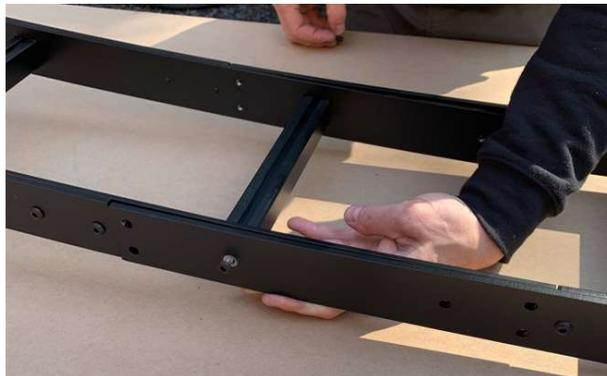
1.6. Mettre une goutte d'adhésif bloqueur de filets sur les 10 boulons 1/4" -20 x 1/2". Insérer manuellement tous les boulons en alignant les 2 sections d'échelles ensemble.
