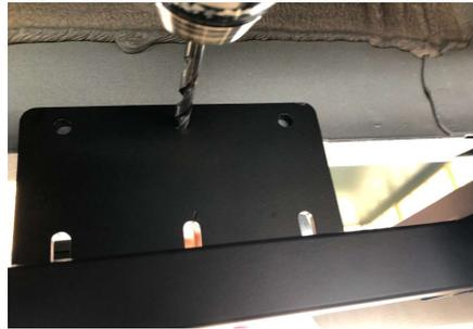
5.4 Insérer une rondelle d'espacement sur un boulon à tête hexagonale 1/4"-20 x 1". Insérer l'assemblage au travers de la lèvre de métal et de la plaque de transition.
