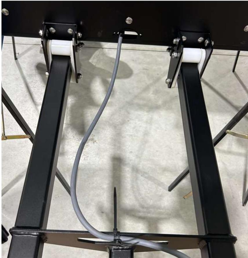
15 Attacher le fils électrique des lumières avec un tie wrap au tube en Y
