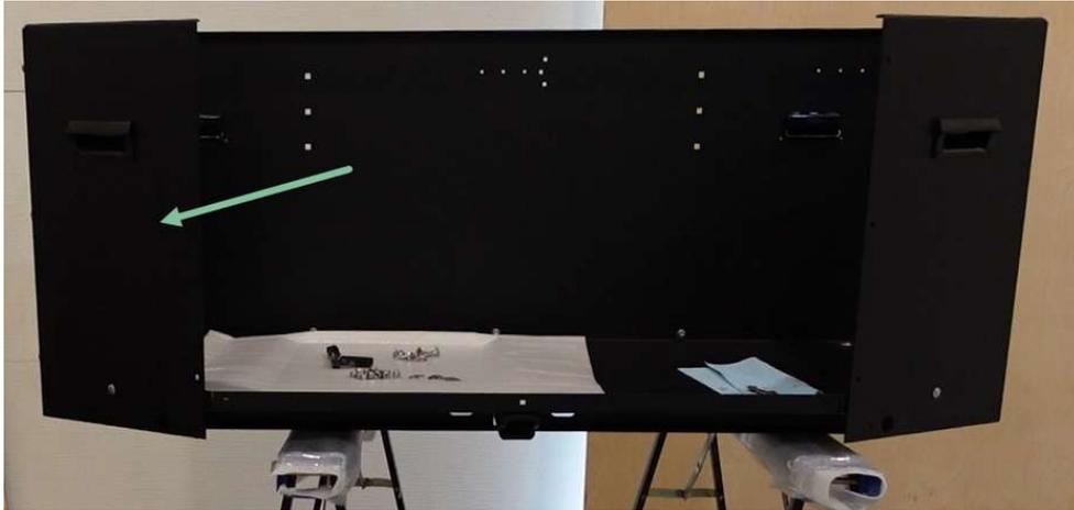
f. Installer le panneau avant (avec loquet principal pré-installé)
