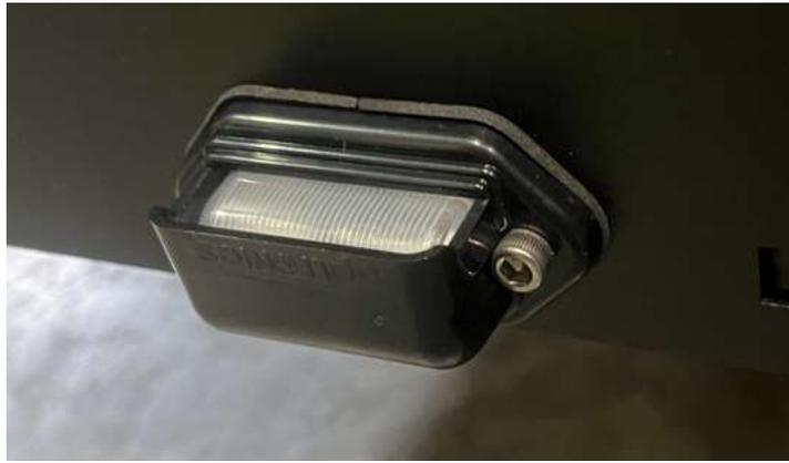
Clipper le filage électrique des lumières, les passer dans les alésages prévus à cet effet et les attacher au coffre avec des tie-wraps.
