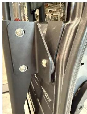
6.11. Insérer le boulon dans le néoprène et les alésages fait dans le véhicule.
