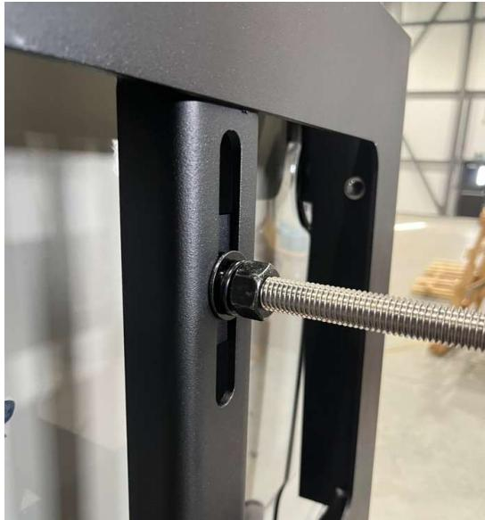
7.3. Positionner le boulon selon de rayon de votre pneu et serrer fortement l'assemblage en place
