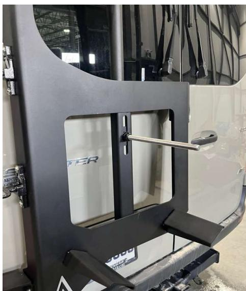
7.4. Déposer votre pneu sur les appuis pneus et insérer au travers du boulon 5/8"
