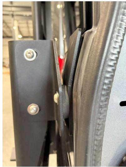
6.14. Serrer tous les boulons de l'assemblage à un torque de 30 Nm.
