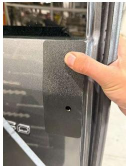
6.10. Positionner le néoprène 3/8" vis-à-vis l'alésage et le coincer entre la tôle support centre et la tôle renfort.
