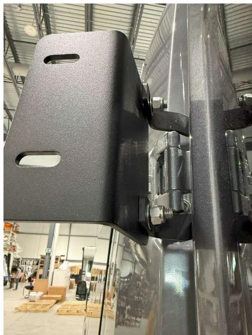
4.3. Insérer la plaque de penture supérieure devant le support en L, insérer les rondelles sur les boulons et visser les écrous manuellement.
