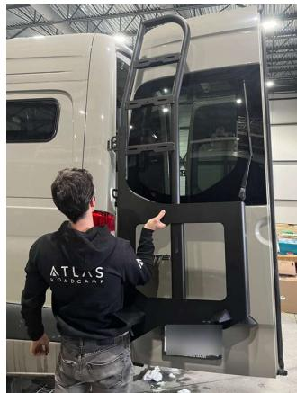
5.2. Insérer la rondelle sur le boulon. Insérer le boulon au travers la plaque intermédiaire et du support.
