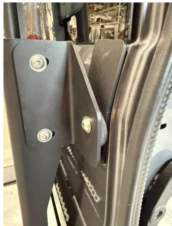
6.12. À l'intérieur de la porte, mettre de l'anti-seize sur les filets. Insérer une rondelle de néoprène, une rondelle 3/8 et visser un écrou 3/8" manuellement. Cette étape est délicate, il faut faire attention de ne pas échapper l'écrou dans la porte.
