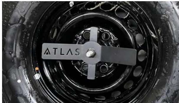
7.7. Visser le boulon  $\frac{1}{2}$ " dans le trou au bout du boulon  $\frac{5}{8}$ " et visser l'écrou sur le boulon pour barrer le tout en place
