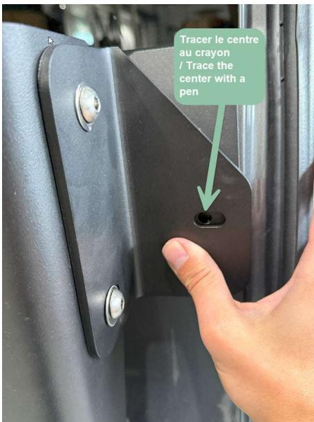
6.6. Percer à l'aide d'une mèche 3/16" la paroi extérieure + la 2<sup>e</sup> paroi à l'intérieur de la porte (il y a donc 2 tôles à percer 3/16")
