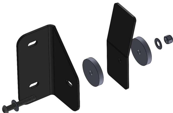
6.13. Serrer l'assemblage jusqu'à ce que le néoprène extérieur soit légèrement bombé. Approximativement 12-16 Nm.
