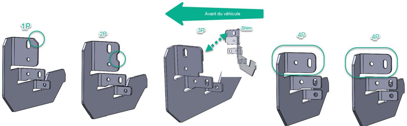
Schéma de positionnement des supports côté passager
