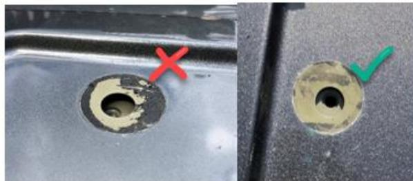
1.4 Il est possible que l'alésage fileté et le trou dans la tôle du toit soient mal alignés.
