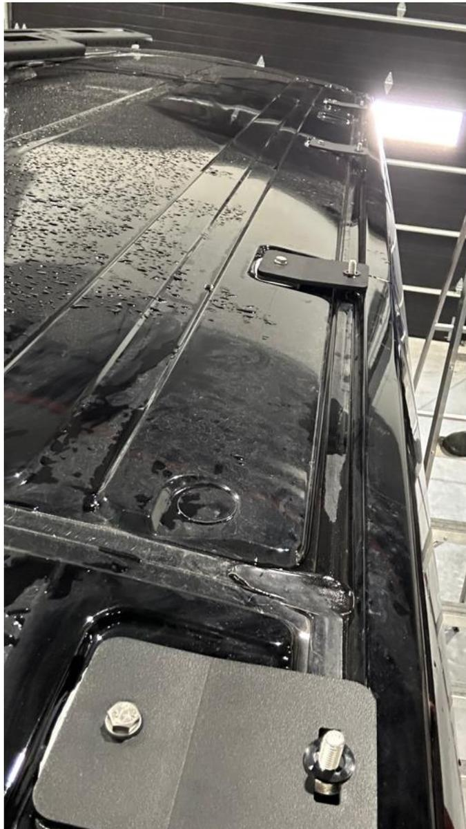
2.2. Déposer un longeron sur les plaques en agnle en insérant le boulon de carrosserie dans un trou oblong central du longeron.
