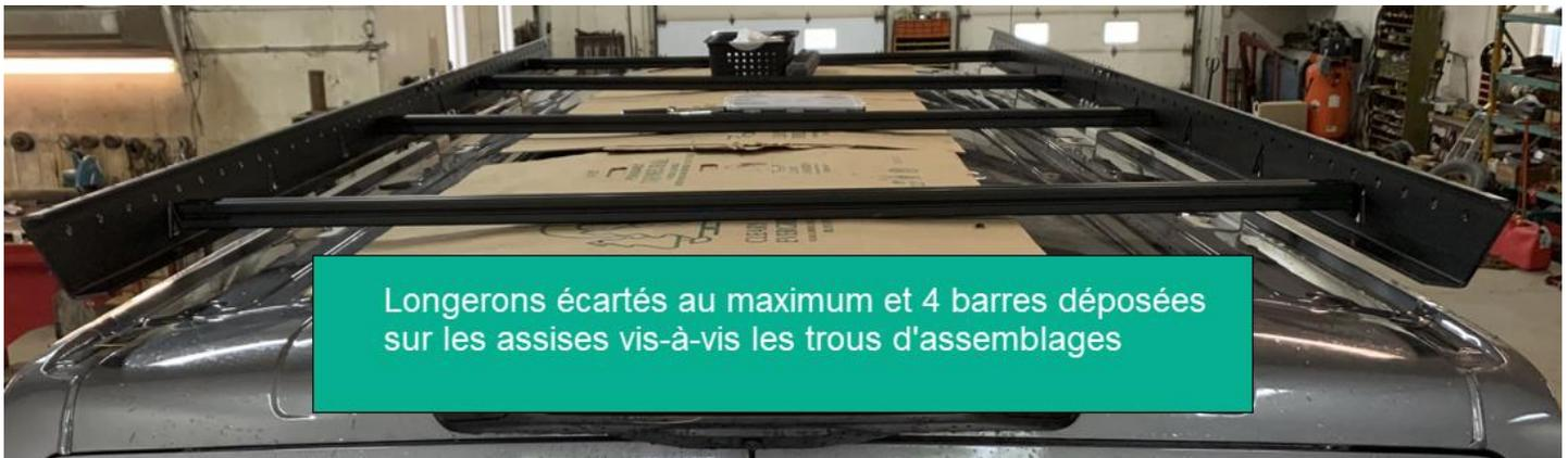
Longerons écartés au maximum et 4 barres déposées sur les assises vis-à-vis les trous d'assemblages
