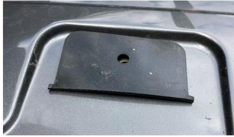
1.7 Appliquer généreusement un 2<sup>e</sup> cordon (environ 1/2'' de diamètre de cordon) de SikaFlex221 sur le caoutchouc sur toute la circonférence de l'alésage
