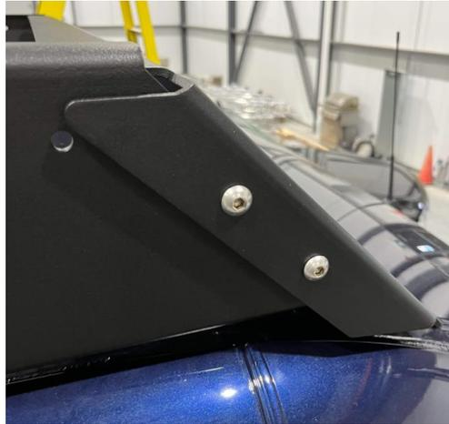
5.1.3. Insérer la rondelle d'espacement et l'écrou 3/8''-16.
