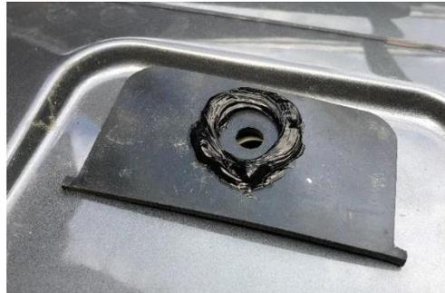
1.8 Assembler les plaques d'ancrages en angles avec le toit du véhicule
